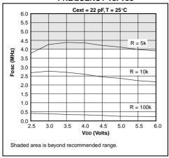
FIGURE 14-6: TYPICAL RC OSCILLATOR FREQUENCY vs. VDD
