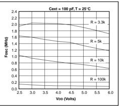
FIGURE 14-7: TYPICAL RC OSCILLATOR FREQUENCY vs. VDD
