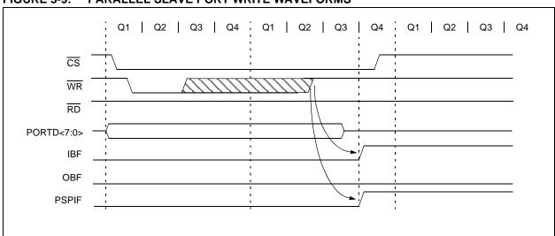
FIGURE 3-9: PARALLEL SLAVE PORT WRITE WAVEFORMS
